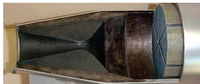
Fig. 9. Configuración general y terminología de las partes de una tobera (Nasa, 1975).
